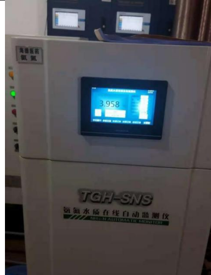
废水氨氮在线自动监测仪
