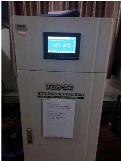
废水化学需氧量在线自动监测仪
